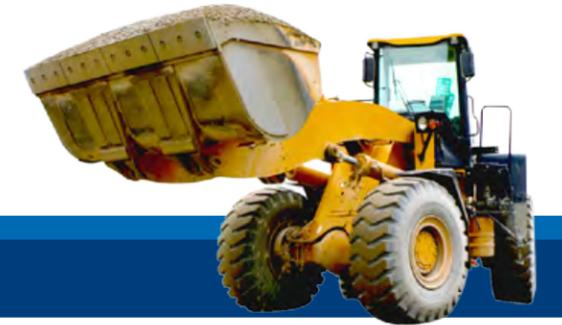
Ковши общего назначения имеют удлиненную нижнюю створку, что позволяет глубже проникать в материал. Широкий угол зева ковша даёт лёгкость заполнения, а боковые стенки закруглённой формы эффективно удерживают материал. Такая геометрия даёт возможность заполнить ковш на 110% от фактической ёмкости, что увеличивает производительность работы. Ковши общего назначения изготавливаются из металла повышенной плотности, что делает их более прочными и износостойкими.
